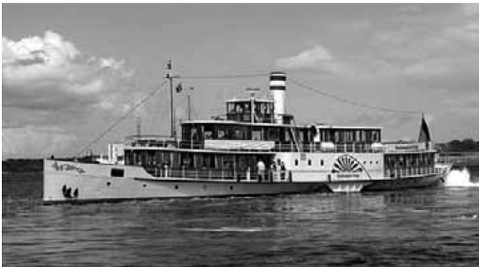
Das Dampfschiff *Freya* ist ein 1905 gebauter stählerner Seitenraddampfer mit hohen in Naturfarben belassenen Holzaufbauten.
